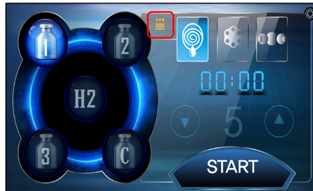
Contenedor de desechos líquidos Alarma de nivel
