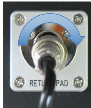
Gire la tuerca para asegurar el cable al conector.
